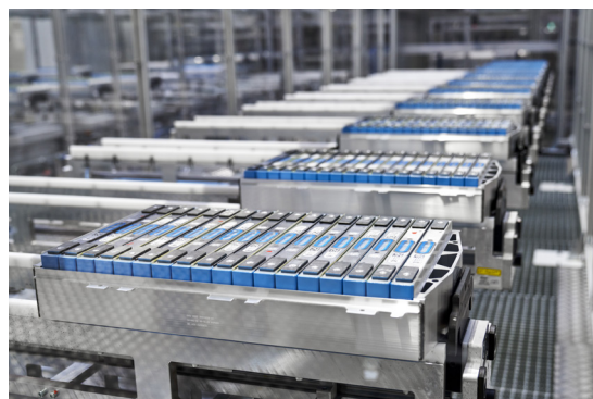
Abb.: Fertigung Batteriemodule
