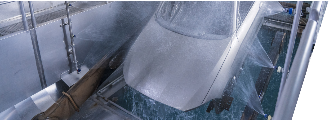
Abb.: Prozessabschnitt Vorbehandlung der Rohkarossen in der Lackiererei
