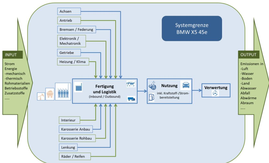
**Abb. 1:** Flowchart Input- / Output-Daten des BMW X5 45e
