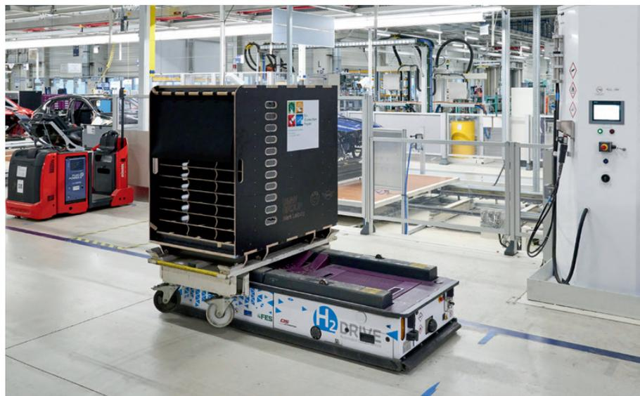
Abb.: fahrerloses Transportsystem mit Brennstoffzellenantrieb
