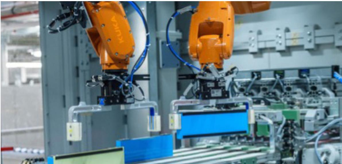
Abb.: Zellen für die Batteriemodulfertigung
