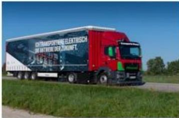
Bild 02: Vollelektrischer Zwischenwerksverkehr: E-Lkw auf der Strecke zwischen dem BMW Group Versorgungszentrum Mamming und dem Dingolfinger Werk 02.20.
