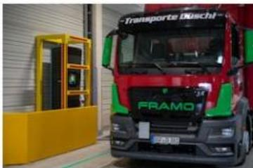
Bild 03 und 04: Vollelektrischer Zwischenwerksverkehr: Die E-Lkw werden direkt während des Be- und Entladens mit Strom betankt.
